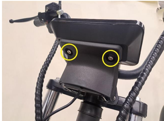
Irrota mittariston taustamuovin kiinnityspultit (kuusiokoloavain 4 mm).
